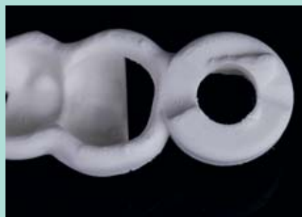
Abb. 8: Detailansicht einer FFF-Bohrschablone, einzelne Schichten sind gut zu erkennen
