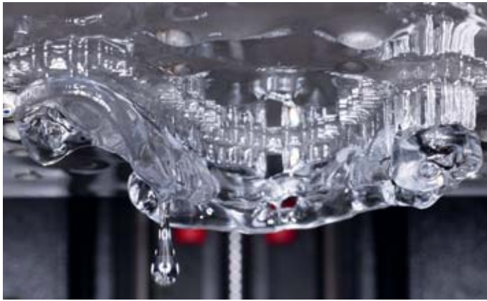
Abb. 2: Mittels DLP gefertigte Bohrschablone unmittelbar nach dem Druck; an der Oberfläche haftendes Harz ist gut zu erkennen.
