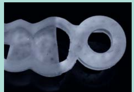
Abb. 9: Detailansicht einer DLP gefertigten Bohrschablone als Vergleich
