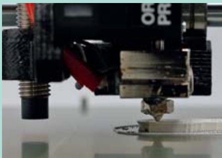
Abb. 4: FFF-Bohrschablone während der Fertigung
