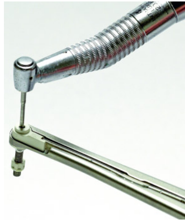
Abbildung 2 Die Jeder-Fräse (Jeder GmbH, Wien, Österreich) besteht aus Führungselement und zentral eingesetztem Fräser.
