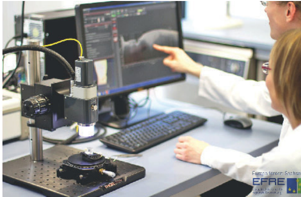
Abbildung 1 Aufbau der OCT-Gerätekonzeption SD-OCT (Telesto II, Fa. Thorlabs, Dachau)
