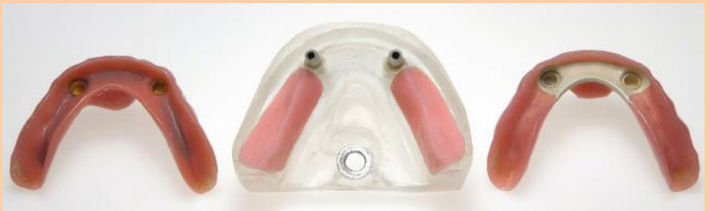
Abb. 9: Galvano-Suprakonstruktion (links), Versuchsmodell mit Titan-Abutments (SKY-Elegance Titanbasis, REF SKYETBML, Bredent, Senden) mittels CAD/CAM-Technik aus Zirkonoxid gefräste Zirkonoxidummantelung (Cercon HT, Dentsply Sirona, Bensheim) (Mitte), PEEK-Suprakonstruktion (BioHPP, Bredent, Senden) (rechts)
