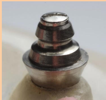
Abb. 4: Die verwendeten Titan-Abutments weisen eine Aufbauhöhe von 6 mm auf mit einem basal breiteren Durchmesser, der sich in okklusaler Richtung verjüngt. Okklusal wurde jeweils eine individuell gefertigte austauschbare Schlitzschraube befestigt.
